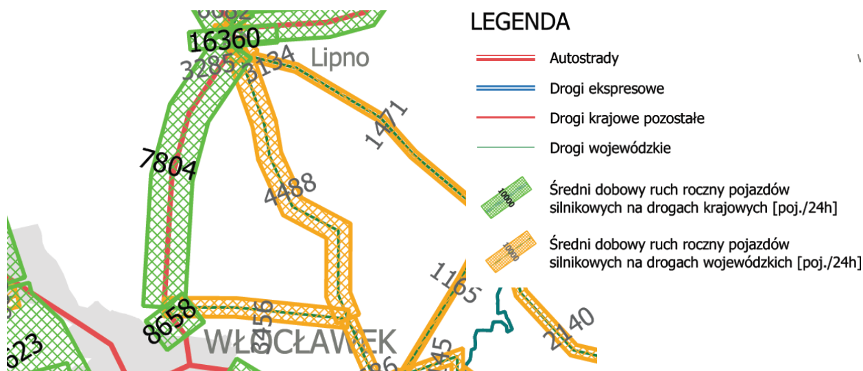
Rysunek 35. Mapa średniego dobowego ruchu rocznego pojazdów silnikowych na drogach krajowych i wojewódzkich. Generalny Pomiar Ruchu 2020/21 Źródło: http://www.gddkia.gov.pl
